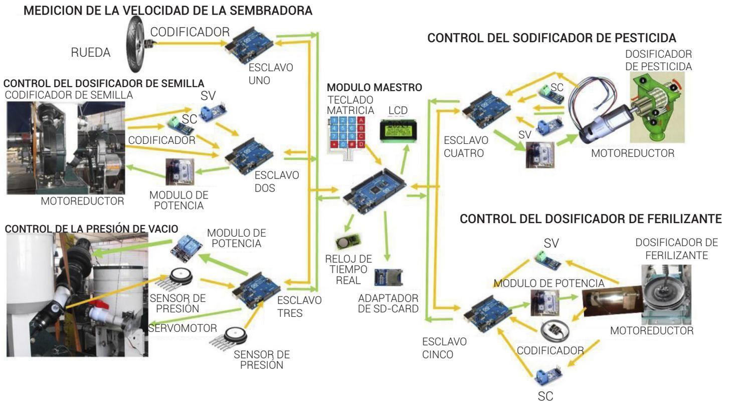
Figura 2. Sistema mecatrónico diseñado para la sembradora-fertilizadora.
