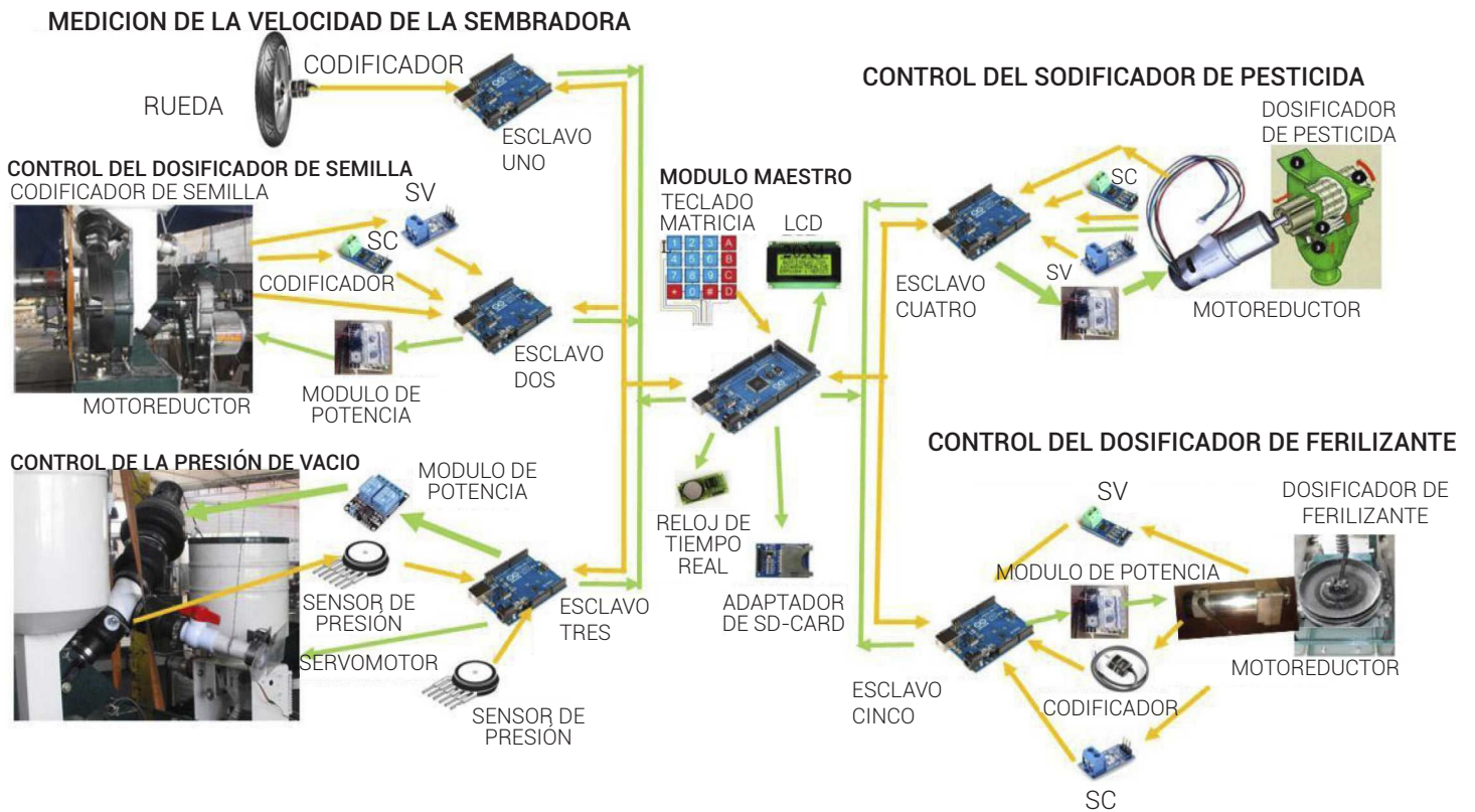
Figura 2. Sistema mecatrónico diseñado para la sembradora-fertilizadora.
